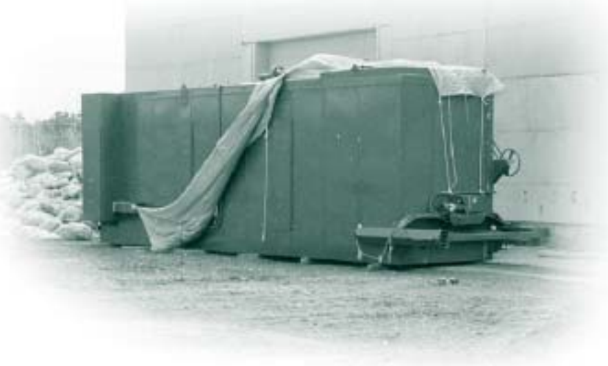
C'est à la base des Forces canadiennes de Gagetown que se trouve un composteur en contenants, deuxième en importance en Amérique du Nord. Le compost produit réduit le besoin d'acheter des fertilisants et des pesticides.
