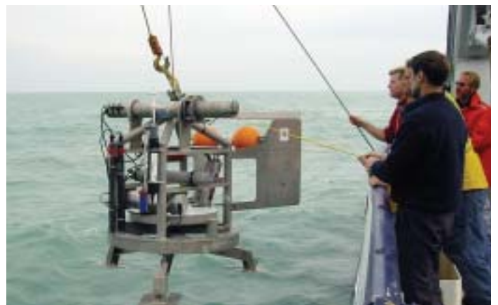
Mouillage de l'INSSECT pour une étude multidisciplinaire du transport des sédiments dans l'ouest de l'Adriatique.
