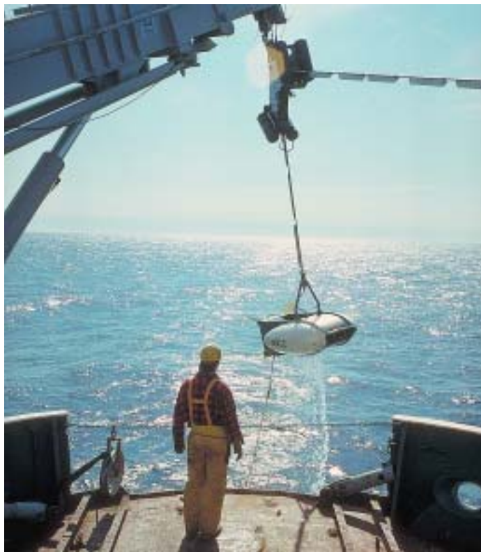
Le système de sismique réflexion à remorquage en profondeur Hunttec (DTS SM ) a été élaboré dans le cadre d'un partenariat entre l'industrie et l'IOB dans les années 1970. Ce système est utilisé dans le monde entier pour obtenir des profils sismiques dans les eaux profondes.
