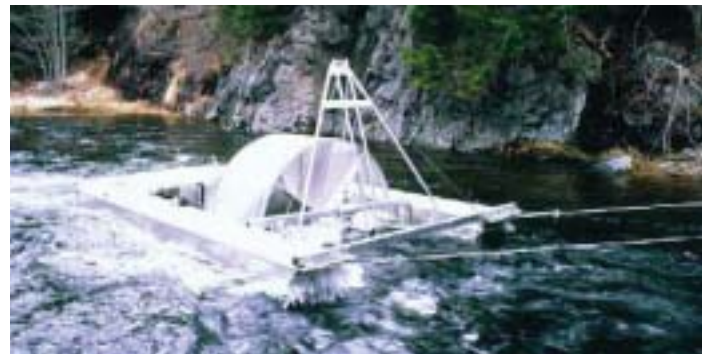
Piège rotatif à vis utilisé pour capturer des saumoneaux de l'Atlantique vivants dans la rivière Big Salmon (N.-B.) - photo de R. Jones.
