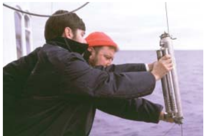
Observation de la température et de la salinité au moyen d'un flacon Knudsen et de thermomètres à renversement.
