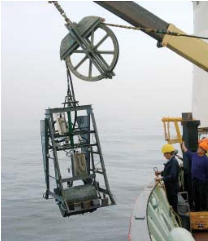
Mouillage à partir du NGCC Hudson d'une benne-vidéo conçue à l'IOB, en juin 2000. La benne-vidéo a servi aux études des incidences des engins de pêche mobiles sur l'habitat benthique.
