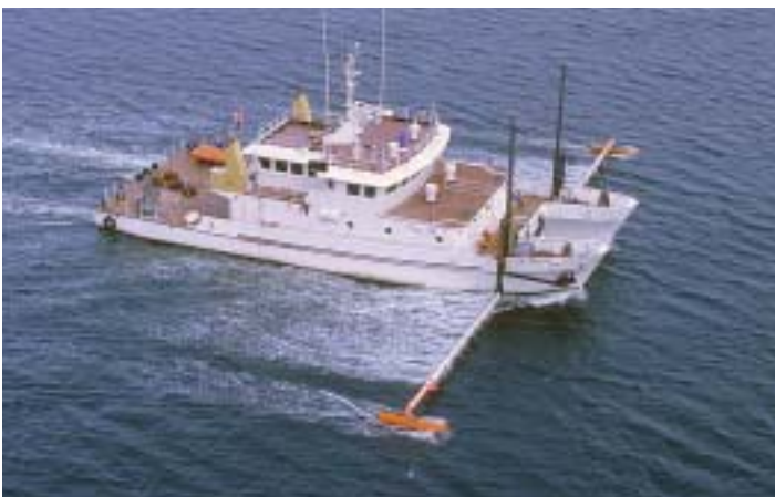
Le NGC F.C.G. Smith effectuant des levés par balayage dans le port de Lunenburg en 1986.
