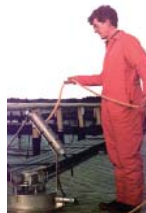
Paul Keizer s'apprête à mouiller une cuve benthique pour mesurer les effets de l'enrichissement organique sous une cage à saumon.
