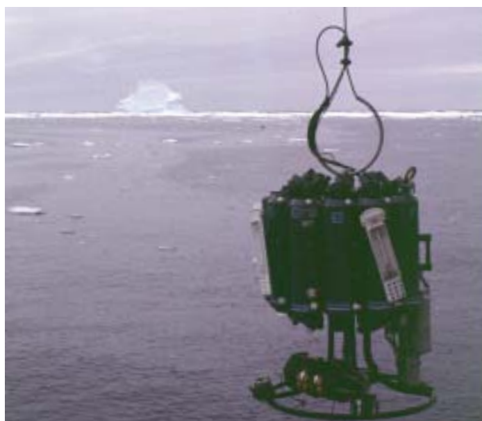
Premier système d'enregistreur de CTP et de rosette d'échantillonnage.
