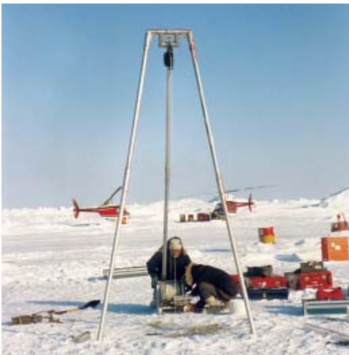
Collection d'échantillons prélevés à la benne Vanveen, de mini-carottes obtenues par gravité et de mesures du flux de chaleur sur le plancher de l'océan Arctique depuis l'île de glace Hobson's Choice (vers 1987) – photo de David Mosher.
