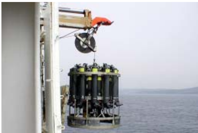
Système moderne de rosette d'échantillonnage CTP.
