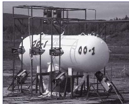
Montage d'essai de soupapes de sûreté
