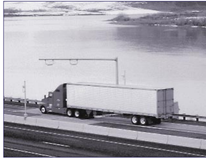
Un camion du projet Green Light passant sous des transpondeurs permettant le pesage dynamique et la préautorisation des véhicules
