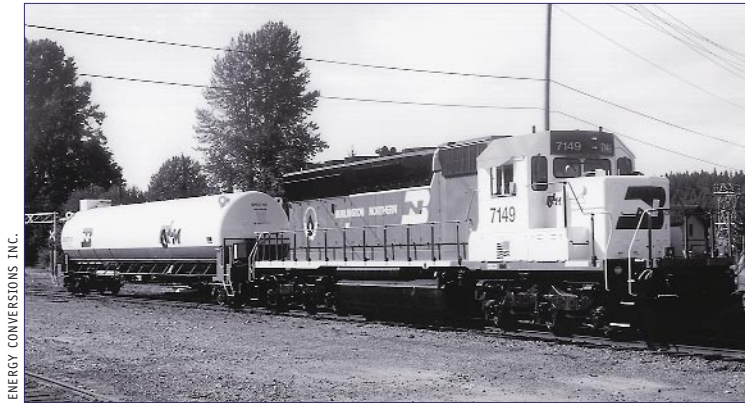
Locomotive mue au gaz naturel liquéfié
