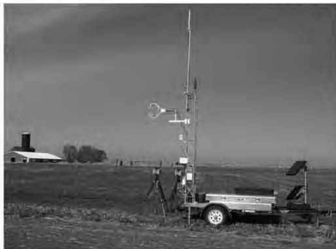
Équipement au laser pour mesurer les émissions de méthane en provenance de fermes laitières
