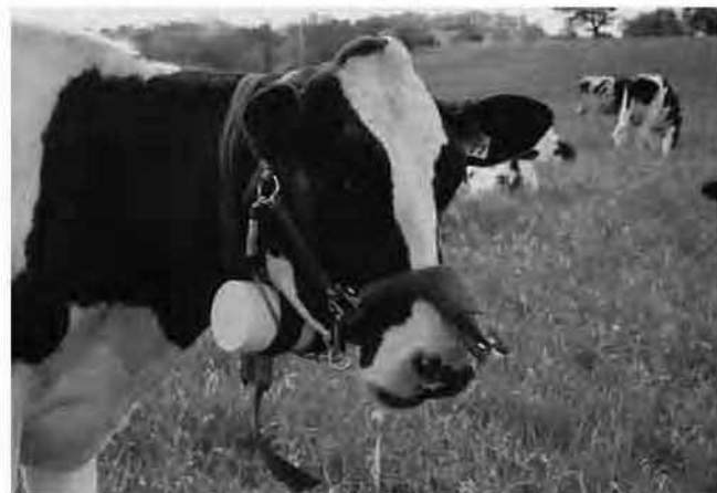
Harnais spécial utilisé pour échantillonner l'air expiré par la bouche de la vache dans le but d'évaluer la production de méthane
