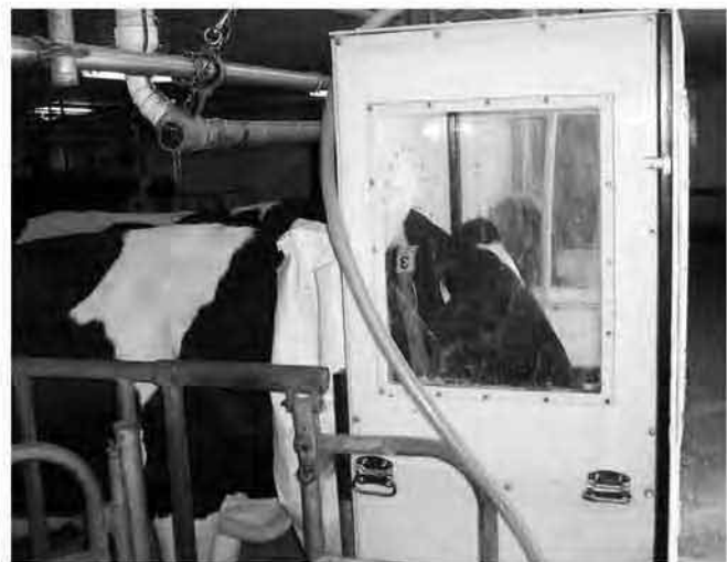
Cloche spécialement conçue pour capter et mesurer le méthane produit par la vache
