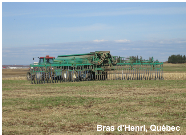
Figure 4: La PGB relative à la gestion du lisier de porc utilise des épandeurs équipés de tuyaux traînants afin de réduire les pertes d'azote dans l'atmosphère.
