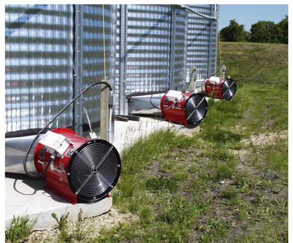
Unité d'aération : ventilateur utilisé pour abaisser le taux d'humidité et la température du grain
