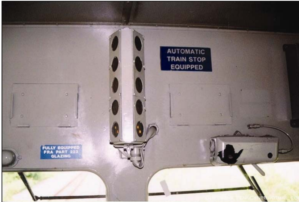
Photo 2. Système typique de signalisation en cabine (source : site Web Railway Technical, www.railway-technical.com )
