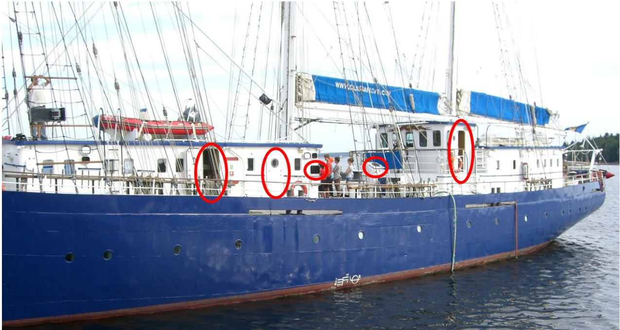
Photo 3. Certaines ouvertures critiques du côté bâbord
