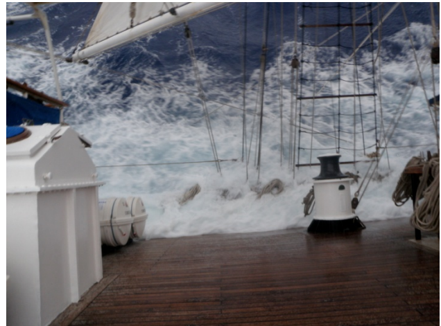
Photo 5. Immersion du bastingage bâbord à 41°
