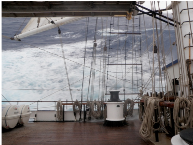
Photo 4. Immersion du livet de pont bâbord à 29°
