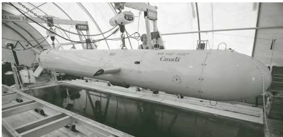
Figure 6C Image de l'AUV au camp de glace Borden, avant son envoi en mission. Également illustré, le grand trou aménagé en retirant plus de 30 000 kg de glace. Photo : Janice Lang, DRDC.
