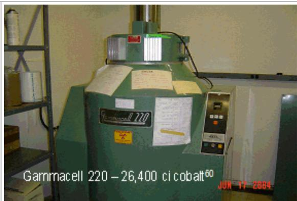
Image 1 : Irradiateur Gammacell au cobalt 60
