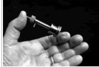
Image 11 : Détecteur à capture d'électrons
