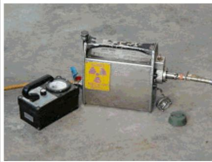
Image 5 : Caméra de gammagraphie industrielle qui contient la source radioactive scellée
