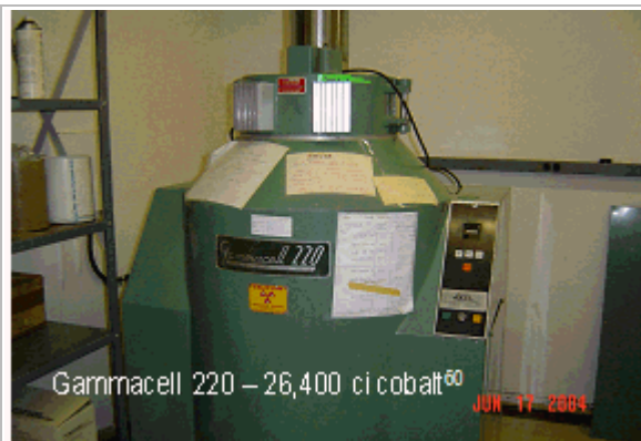
Image 1 : Irradiateur Gammacell au cobalt 60
