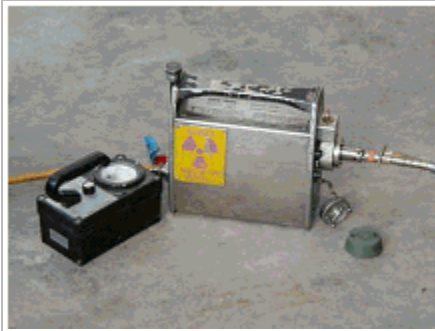
Image 5 : Appareil de gammagraphie industrielle contenant une source scellée radioactive
