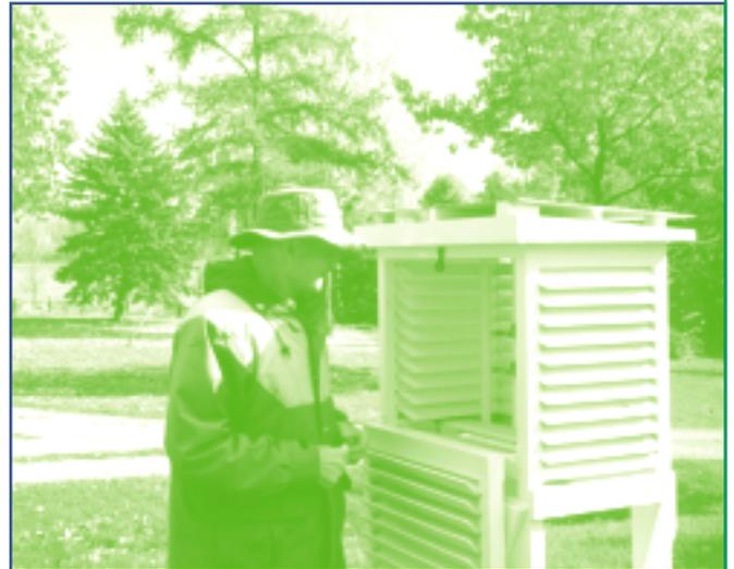
*Un observateur du climat bénévole prend les mesures de l'équipement situé dans une boîte spéciale de protection perméable à la température, appelée abri Stephenson.*
