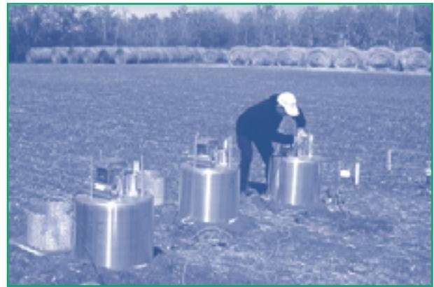
*Des chambres à flux sont disposées dans un champ de canola pour mesurer la volatilisation du lindane à partir des semences traitées.*
