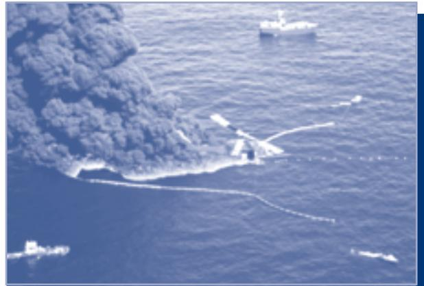
*Dans le cadre d'une expérience sur le terrain visant à déterminer les niveaux d'émission des brûlages dirigés, un hélicoptère prélève des échantillons d'air au-dessus d'une nappe d'hydrocarbures enflammée.*
