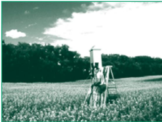
*Un échantillonneur d'air à grand débit mesure les concentrations de lindane et d'autres polluants aéroportés au-dessus d'un champ de canola en Saskatchewan.*
