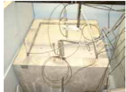
Vue du dispositif expérimental avec LVDT en chambre humide
