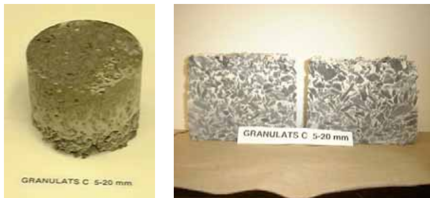
Figure 18 Échantillon C1 (5-20 mm) après injection avec le coulis TER-1
