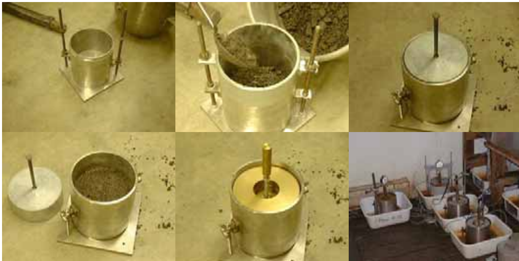
Figure 3 Mise en place des granulats et dispositif expérimental pour l'évaluation du potentiel expansif
