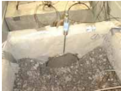
Installation des capteurs de pression latéraux
