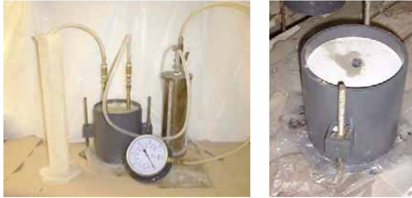
Figure 16 Dispositif d'injection et moule CBR après injection
