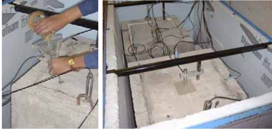
Figure 10 Ajout de la culture bactérienne et vue générale de l'enceinte expérimentale
