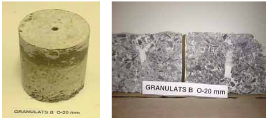
Figure 17 Échantillon B1 (0-20 mm) après injection avec le coulis TER-1
