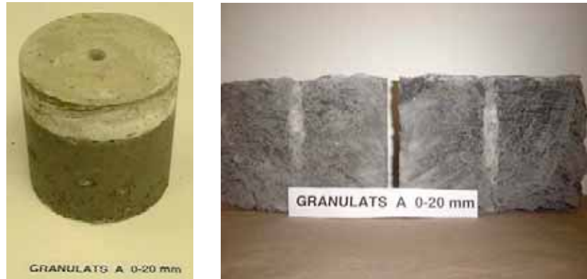
Figure 19 Injection du granulat A-1 par le coulis TER-1
