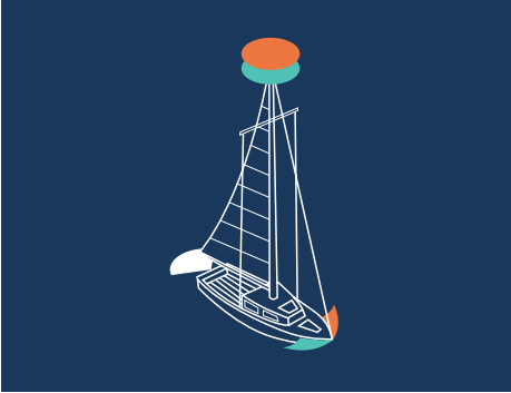
Figure 9-5 Feux superposés visibles sur tout l'horizon
