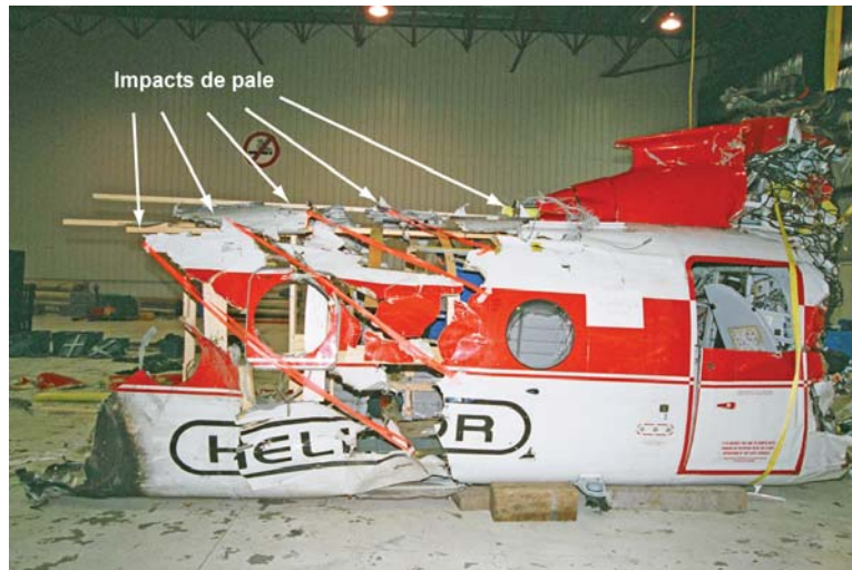
Photo 1. Impacts de pale sur le fuselage
