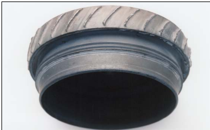
Photo 2. Roue endommagée du troisième étage du compresseur
