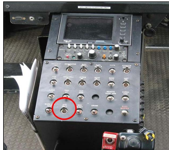
Photo 2. Commutateur d'essai des accumulateurs hydrauliques
