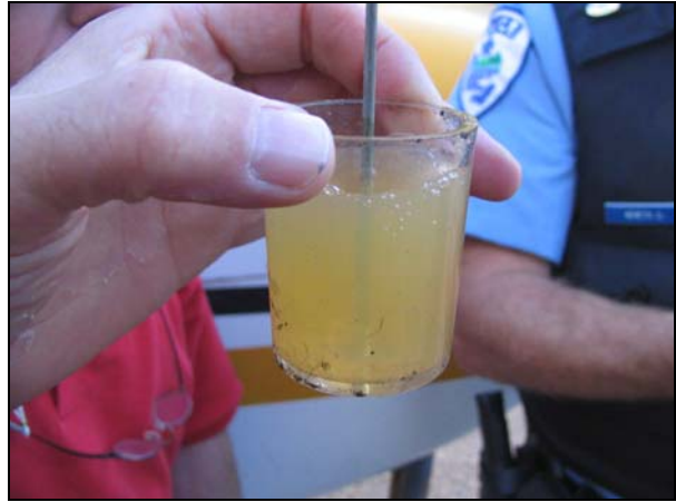
Photo 1. Eau provenant du filtre à carburant
