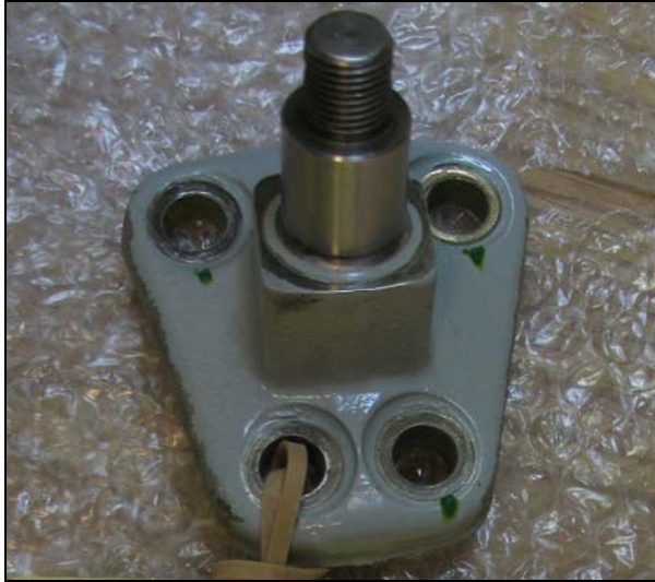
Photo 1. Axe de support de pylône en bon état
