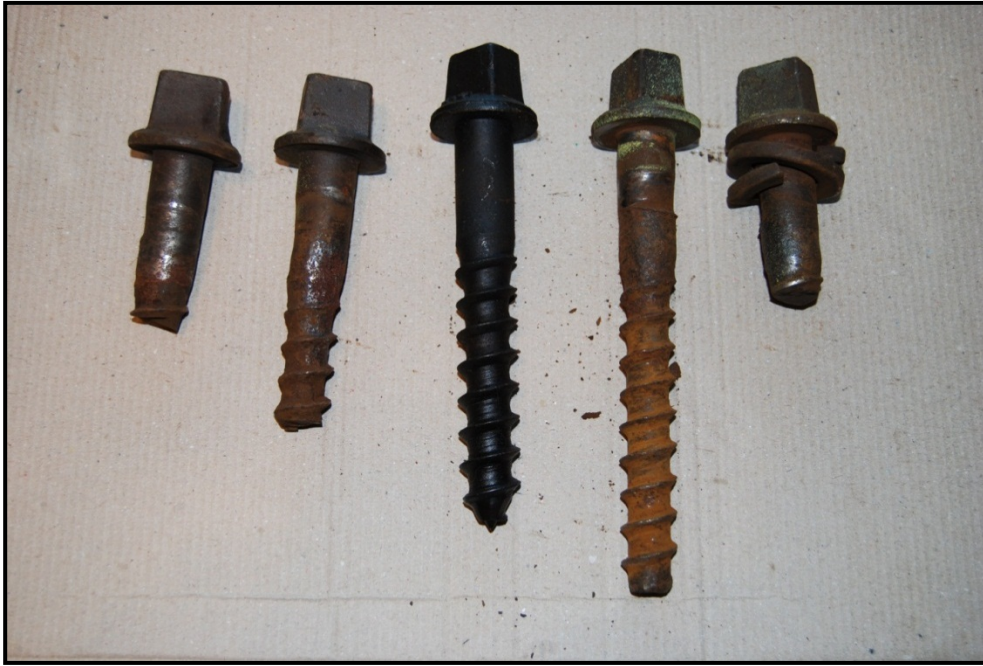
Photo 2. Tirefonds cassés de 8,5 pouces, tirefond neuf de 7,5 pouces (au milieu) et ancien tirefond de 8,5 pouces (2 e à partir de la droite)
