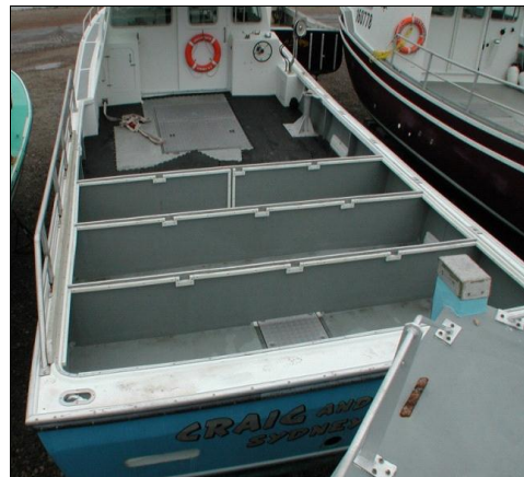
Photo 2. Pont de travail avec épontilles transversales (avec l'autorisation de Briand Marine Surveys)
