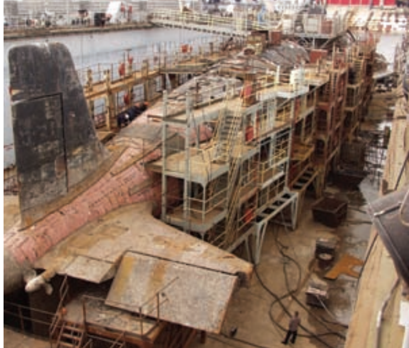
Sous-marin de la classe « Victor I » démantelé dans un dock flottant
