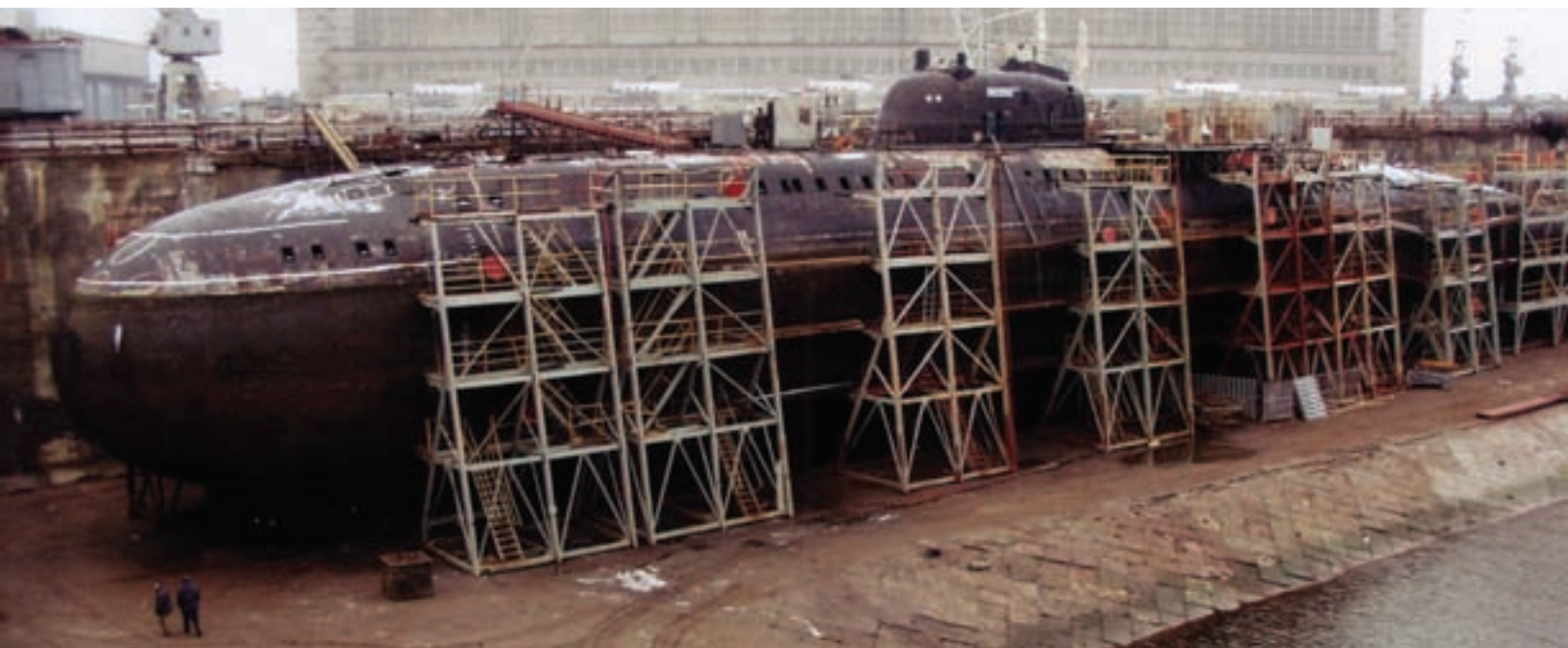
Sous-marin de la classe « Victor III » en cale sèche en cours de démantèlement
