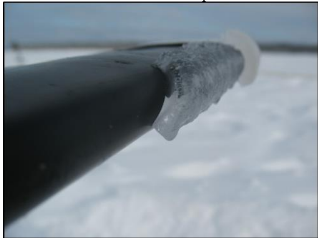
Photo 4. Givre sur le bord d'attaque du stabilisateur horizontal
