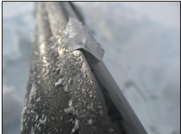
Photo 2. Givre sur le bord d'attaque
