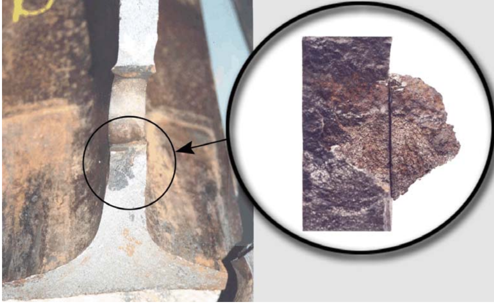
Photo 2. Précricque dans le troisième trou d'éclissage. L'éclaté montre un gros plan de la surface de rupture de la précricque, dont la surface de contact a été retirée.
