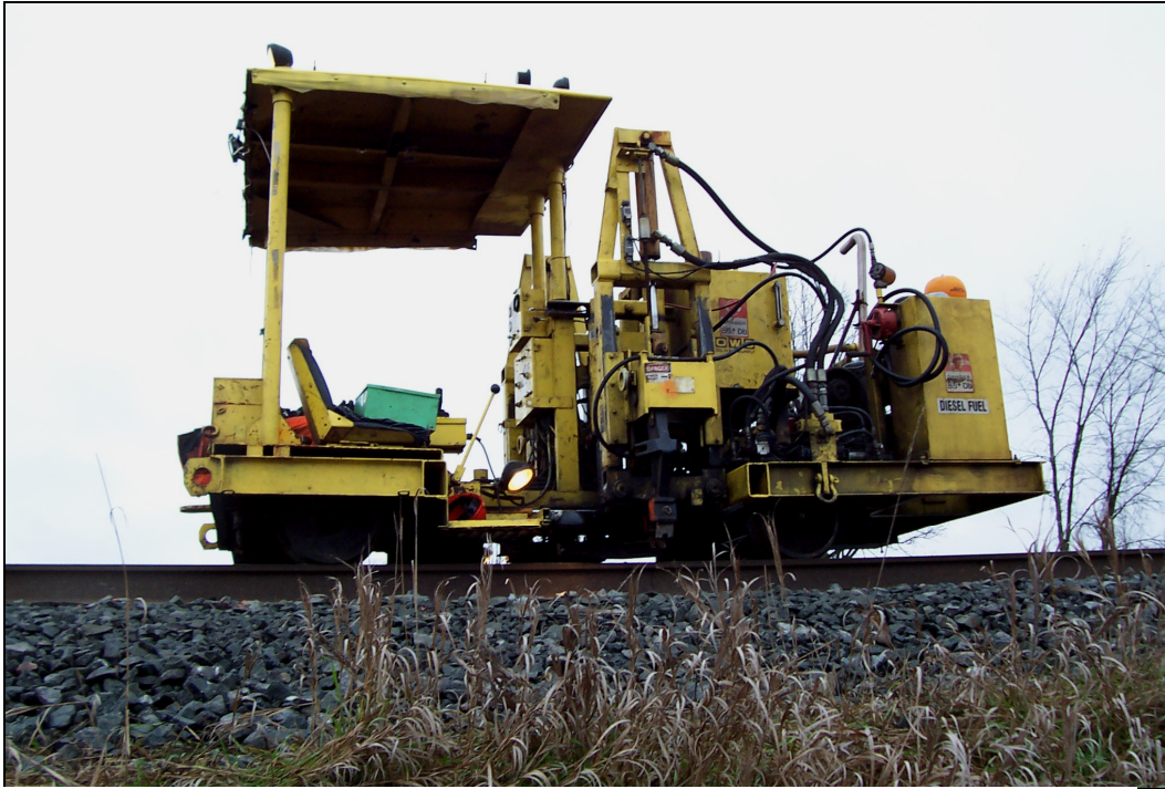
Photo 1. Vue latérale de l'arracheuse de crampons sur les lieux de l'accident (Source : Ministère du Travail de l'Ontario)
