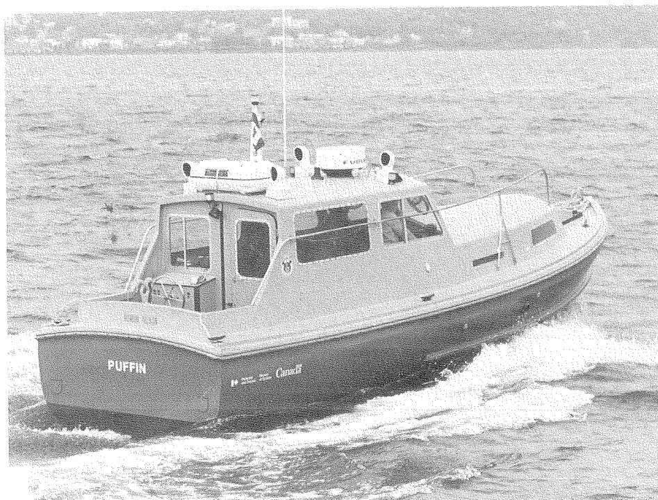
La V.H.C. Puffin est une nouvelle vedette hydrographique; dotée d'une coque ronde de fibre de vers à semi-déplacement, est capable d'atteindre vingt noeuds à pleine vitesse.
