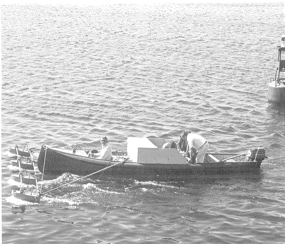
Fig. 3 Système de balayage Raytheon 719 avec la structure mise au point par le Service hydrographique du Canada
