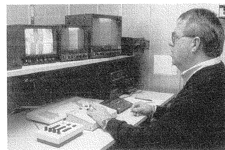
Figure 3 : Photographie du système d'irradiation aux rayons X du CGA. La carotte est insérée verticalement dans un habitacle commandé par ordinateur qui la déplace et la fait pivoter pendant que l'opérateur observe les données obtenues par rayons X sur un moniteur à affichage vidéo.
