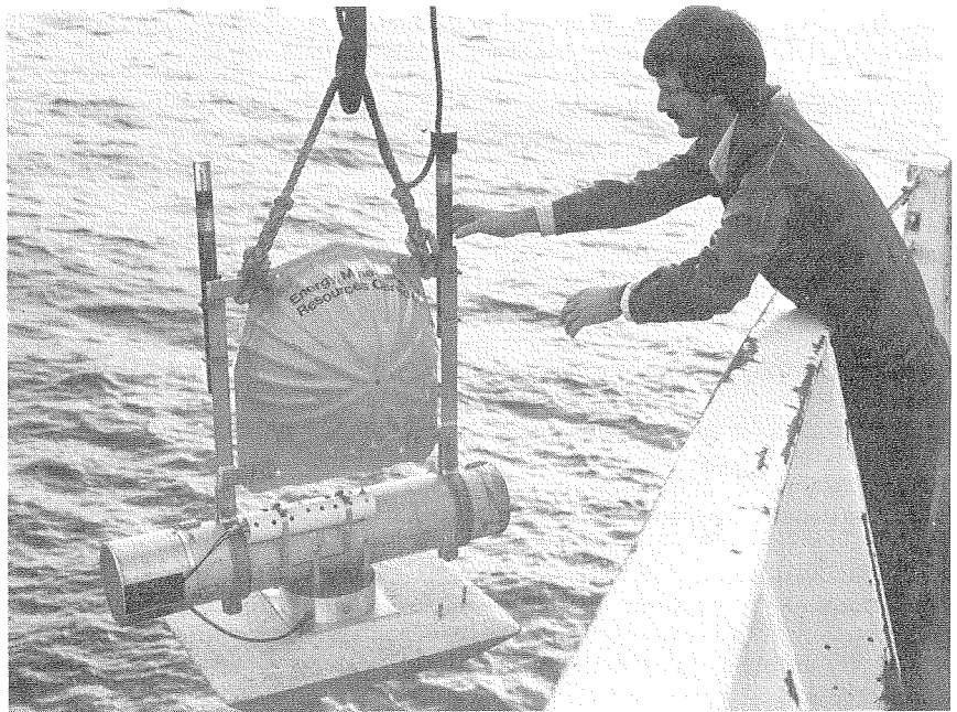
Installation d'un séismomètre de fond marin. (LOA 4095)
