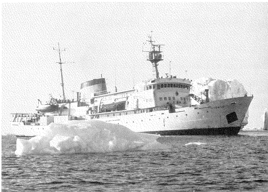
Le CSS Hudson est un navire à propulsion diesel-électrique conçu pour la recherche océanographique et le travail de levé hydrographique. (IOB 4926-C-7)
