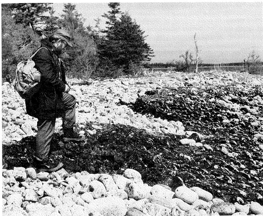
Les restes du pétrole Bunker C de la marée noire de l'Arrow en 1970 couvrent encore une partie du littoral de la baie Chedabouctou en Nouvelle Ecosse et des ses environs. L'analyse continue de tels résidus nous renseigne sur la dégradation naturelle et les taux d'auto-nettoyage par l'action des vagues et l'évaporation, comme ici dans l'anse de Black Duck. (IOB 3934-41)
