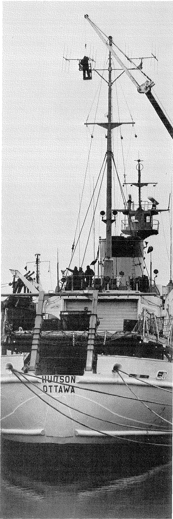
Montage d'antennes VHF à gain élevé sur le mât du n.s.c. Hudson . Ces antennes reçoivent les signaux émis par des bouées acoustiques employées pour les études de géophysique.
