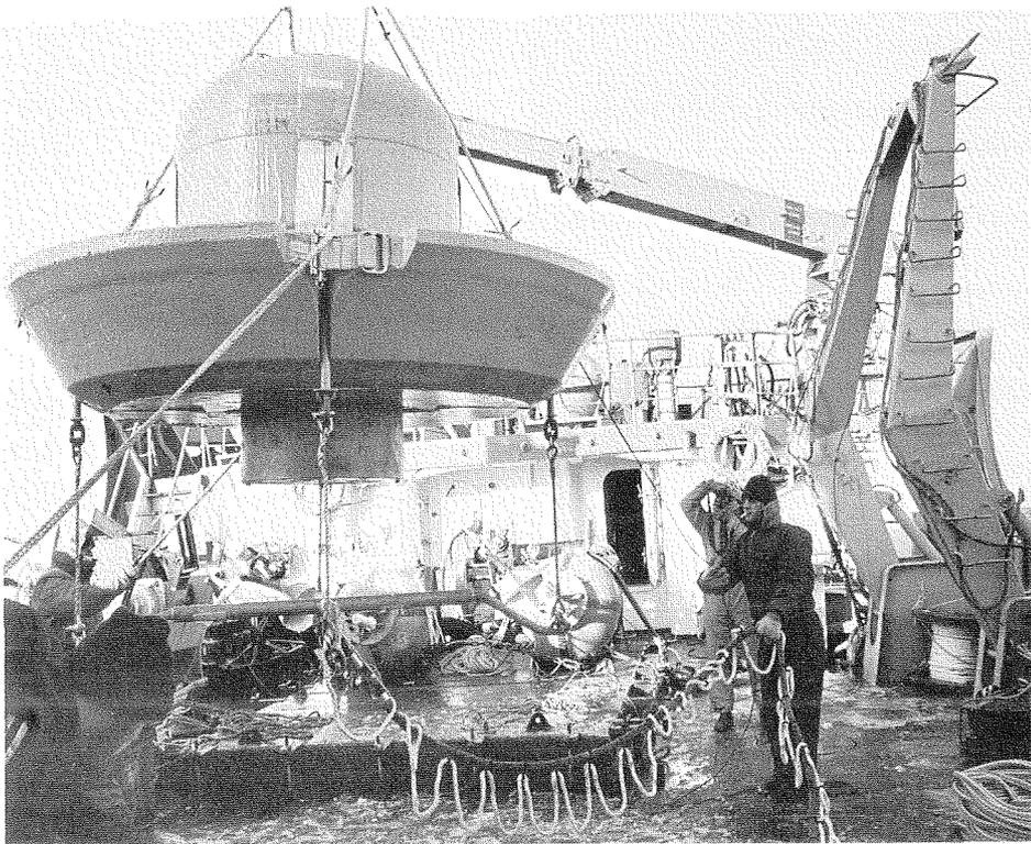
À bord du nsc *Dawson*, en novembre 1985, bouées sur le point d'être mises à l'eau. Ces bouées servent dans le cadre du Programme d'étude des tempêtes dans l'Atlantique canadien à mesurer la hauteur des vagues, et la direction et la propagation des eaux de surface.
