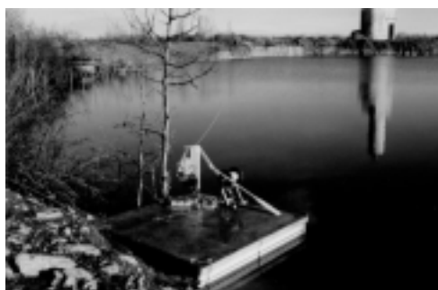
Installation utilisée pour la prise de mesures et d'échantillons dans l'eau des chantiers d'abattage de la mine East Sullivan, illustrés à gauche avant qu'ils ne se remplissent d'eau.
