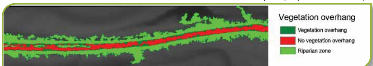
Figure 37 : Végétation surplombante ( vegetation overhang ) - en vert foncé sur la figure - cartographiée avec la technologie du LiDAR (Johansen et al. , 2010).
