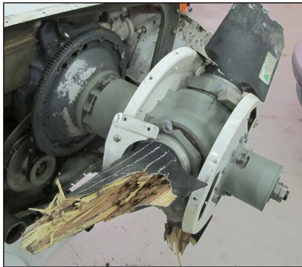
Photo 1. Moyeu d'hélice après l'accident : hélice dans la plage de calage normale.
