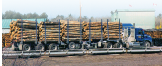
Camion chargé de billes sur une balance de pesée. On calcule la masse du chargement en soustrayant le au poids du camion.
