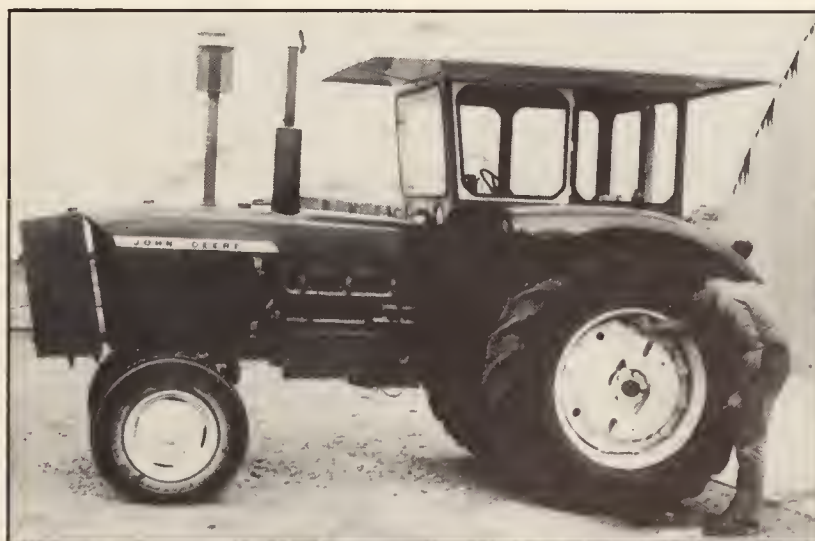
Fig. 5.15 Le lestage s'effectue au moyen de masses de roues et de liquide à pneus
