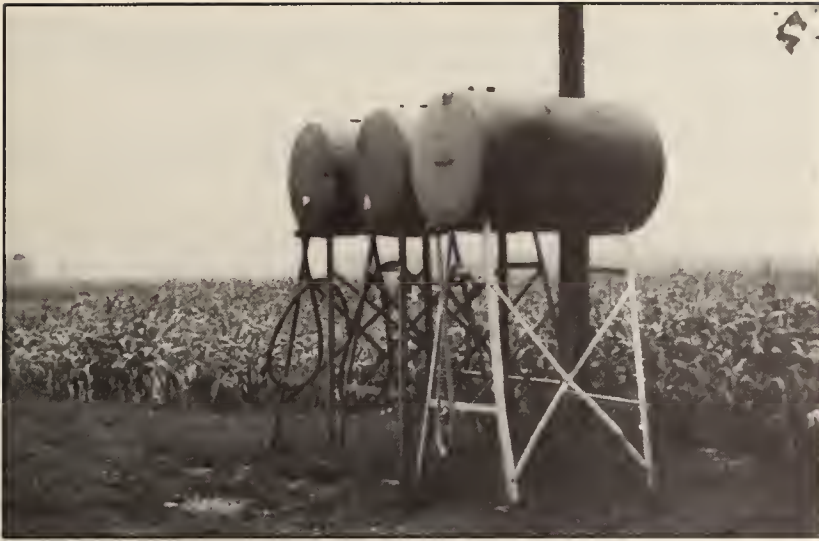
Fig. 2.12 a) Les pertes par évaporation sont les plus élevées dans le cas des réservoirs d'essence exposés au soleil et de couleur foncée.
