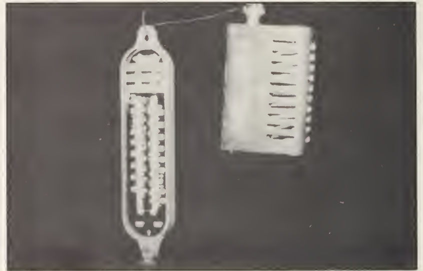
Fig. 7.12 Vérifier régulièrement les thermostats à l'aide d'un bon thermomètre
