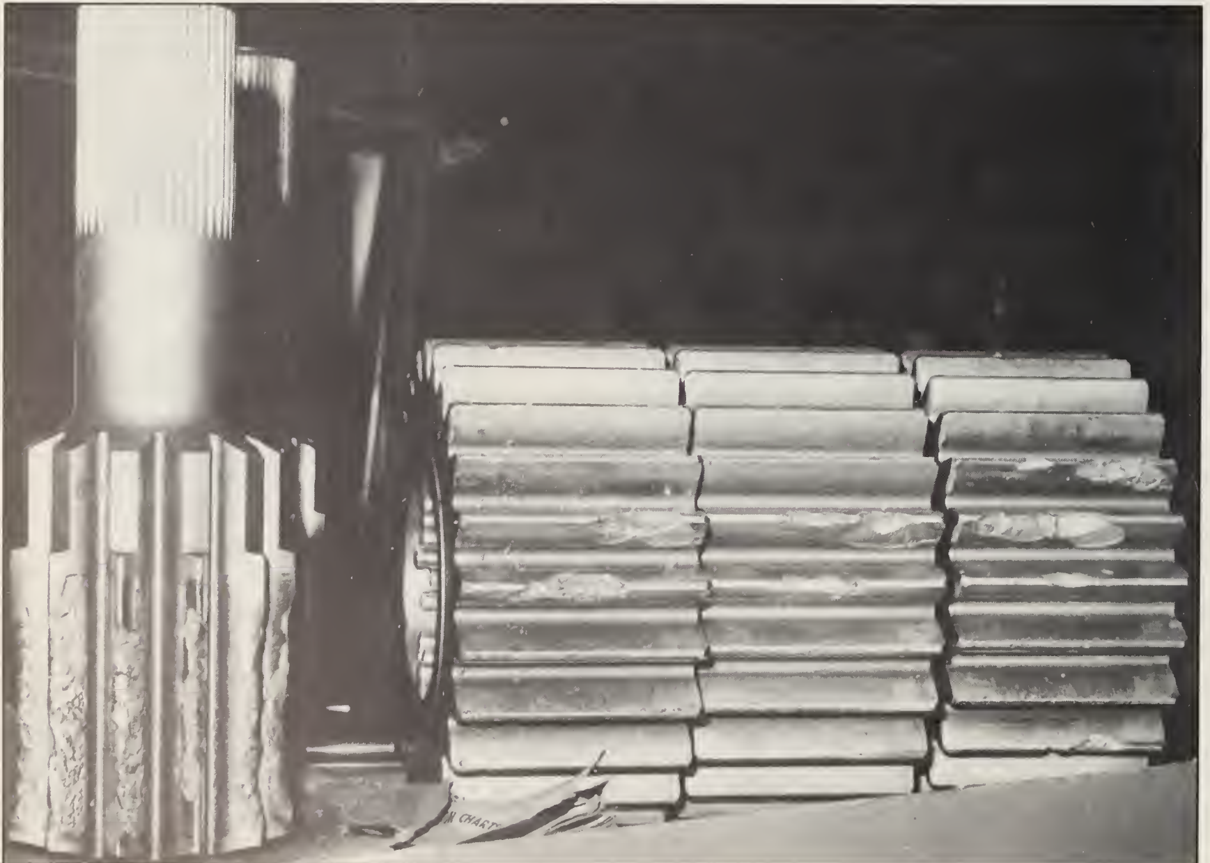
Fig. 5.12 Le surlestage entraîne des avaries coûteuses au groupe propulseur.
