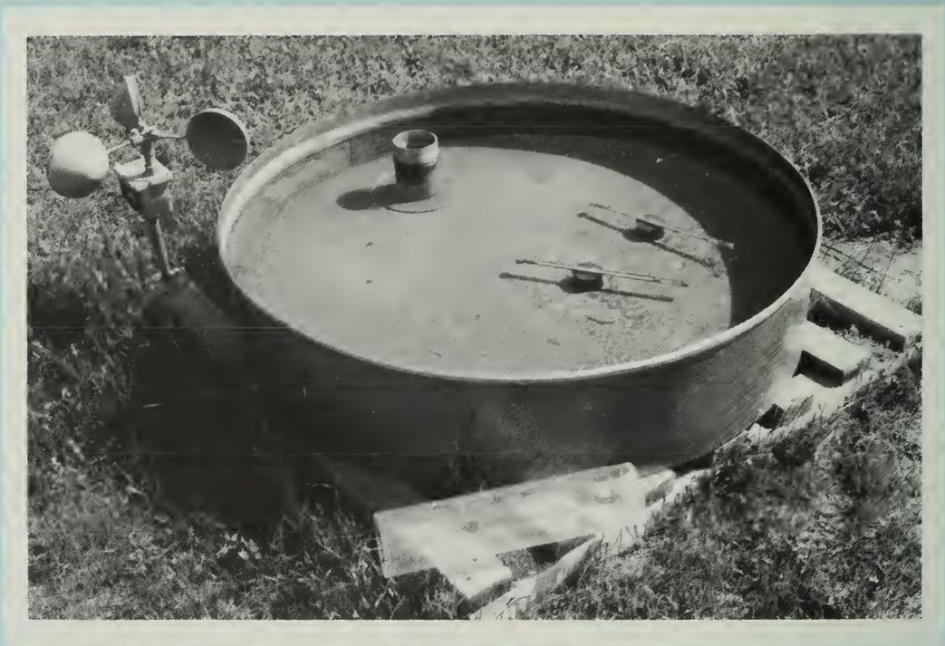
Fig. 12. Bac d'évaporation classe A
