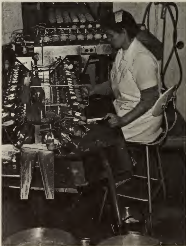
Fig. 30 — Décoquillage des oeufs à la machine pour la congélation ou la dessiccation.
