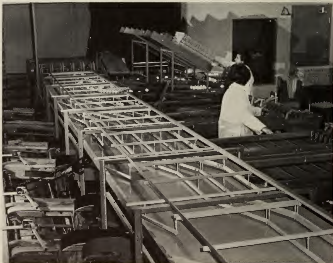
Fig. 19 – Les oeufs de différente grosseur sont transportés séparément à une emballeuse automatique.
