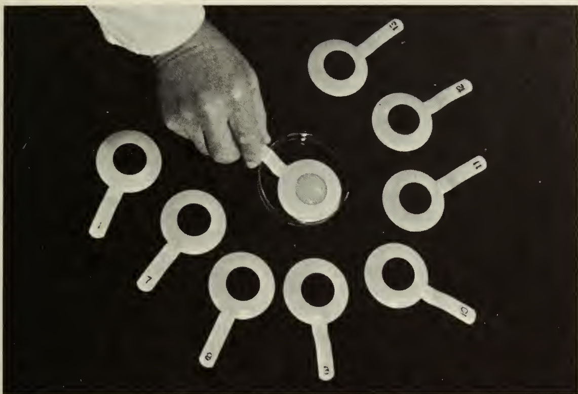
Fig. 6 — Identification de la nuance exacte du jaune au moyen des disques de Fletcher. Cette échelle comprend 15 disques concaves, avec manches, en aluminium coloré. Les 15 tons qui constituent les normes vont du jaune pâle n° 1 à l'orange foncé n° 15.
