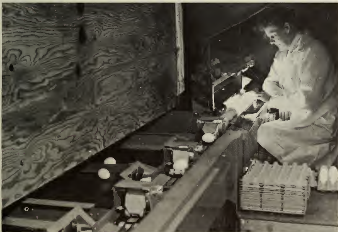
Fig. 17 – Les oeufs de la catégorie A sont transportés sur une série de balances successives, réglées selon les normes de poids prescrit pour chaque classe d'oeufs. L'oeuf qui atteint la balance correspondant à son poids est automatiquement transféré dans un compartiment approprié.
