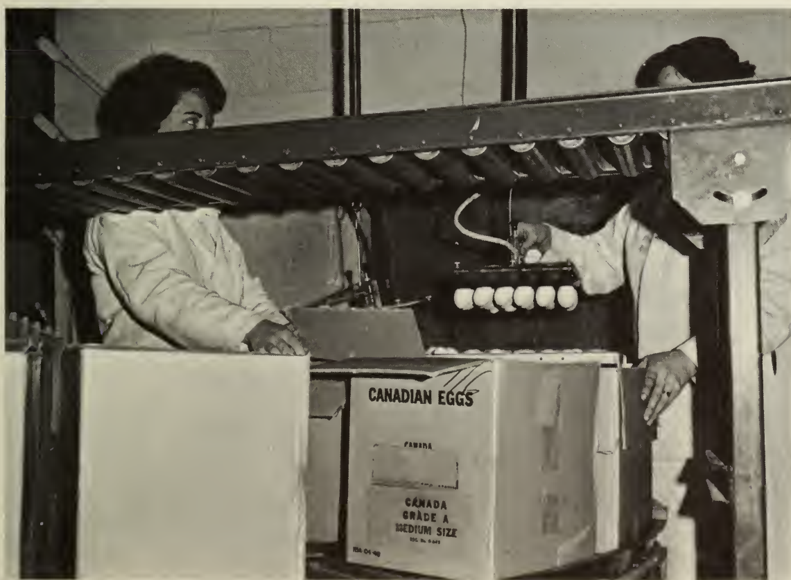
Fig. 13 — Élévateur à vide utilisé pour transférer les oeufs des plateaux aux machines qui lavent et classent les oeufs.
