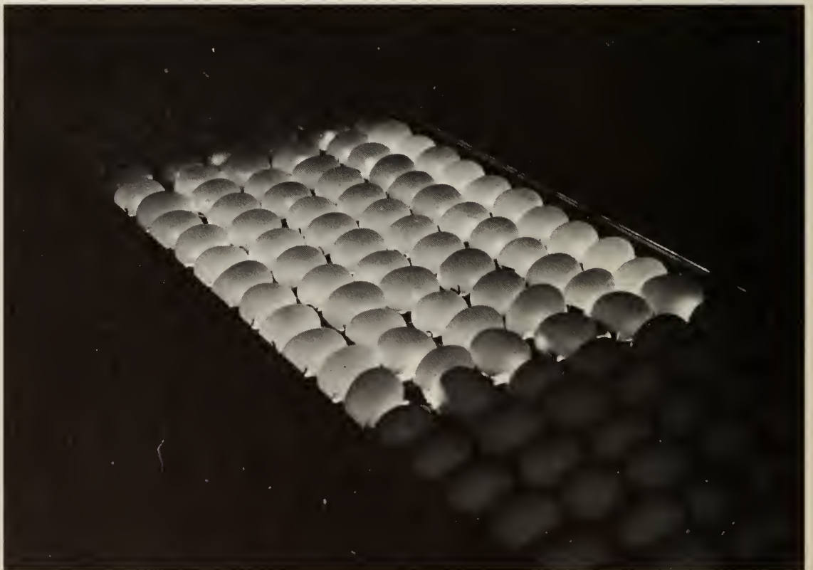
Fig. 15 – Après le lavage et le séchage, les oeufs passent au-dessus d'une surface éclairée par le dessous. En avançant les oeufs subissent automatiquement plusieurs rotations qui permettent ainsi le mirage éclair.
