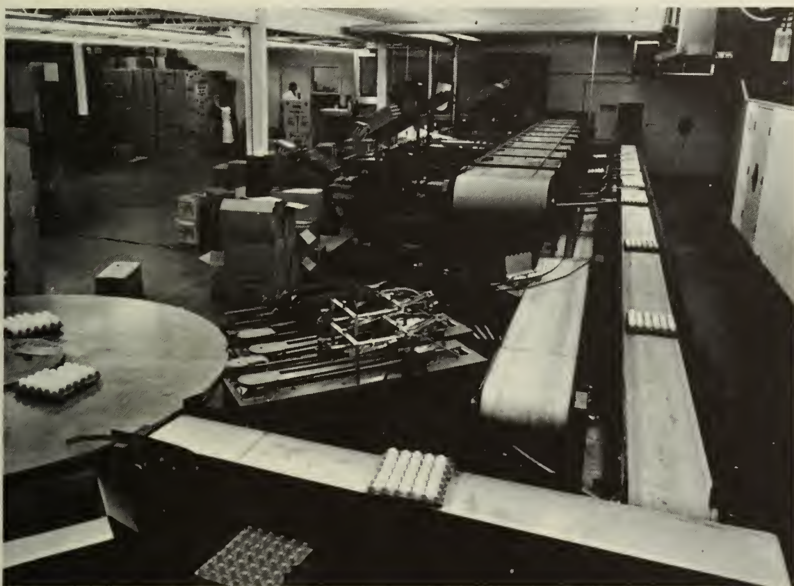
Fig. 24 — Vue de l'équipement qui sert au lavage, au mirage massal, au pesage en rang et à l'emballage automatique d'un volume d'oeufs pouvant atteindre 60 caisses à l'heure.
