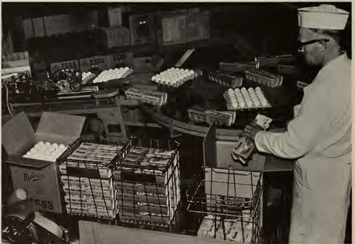
Fig. 23 — Les cartons fermés et scellés parviennent à la table d'emballage rotative où ils sont groupés puis emballés dans des contenants pour être expédiés aux dévoués de détail ou de gros.
