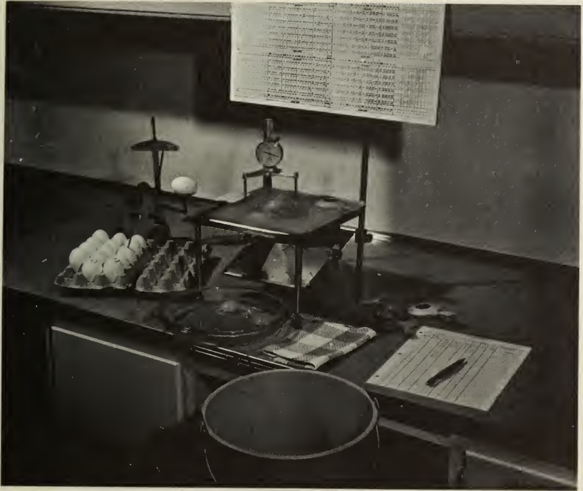
Fig. 28 — Équipement requis pour déterminer la qualité des oeufs décoquillés d'après la méthode de la notation en unités Haugh.
