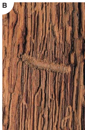
Galerie de pont (transversale, 5 à 20 mm de longueur) et galeries larvaires (verticales, 10 à 15 cm de longueur).
