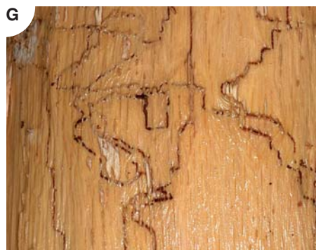
Galleries forées par de jeunes larves. Le tracé en zigzag est caractéristique.
