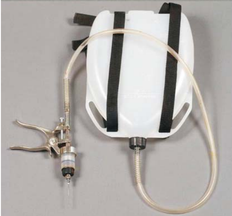
Figure 1. Appareil utilisé pour inoculer la fusariose de l'épi et le charbon commun dans le canal des soies. Un appareil de vaccination gradué, de 10 mL, à remplissage automatique, est relié à un réservoir de 2,5 L porté sur le dos et contenant la suspension de spores fongiques. Injecter 2 mL d'inoculum dans le canal des soies, 4 à 7 jours après l'apparition des soies.
