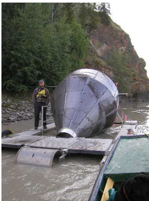
Figure 5. Photographie du piège rotatif installé sur le fleuve Yukon près de Dawson (photo gracieusement fournie par Jim Duncan de la Yukon Salmon Commission).
