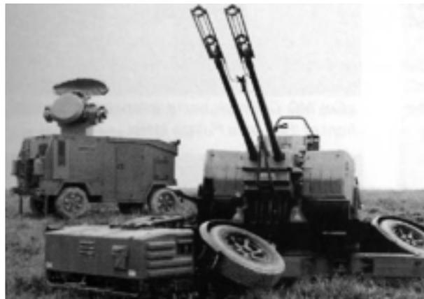
**Le Skyguard et l'arme de 35 mm. Le Skyguard a une portée de recherche radar de 25 km et il engage ses objectifs au moyen d'un radar de poursuite. Chaque Skyguard est généralement relié à deux armes de 35 mm (pouvant être installées jusqu'à 500 m de distance), télécommandées depuis le système Skyguard. Les armes ont une cadence de tir de 1100 projectiles à la minute et peuvent être utilisées contre tous les types d'aéronefs, en plus des missiles de croisière. (Photo du MDN).**
