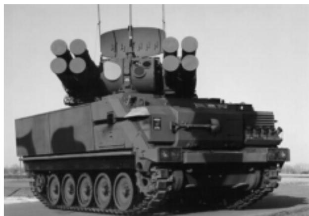
**Le système de missile ADATS est fabriqué au Canada. Il comprend un radar de recherche d'une portée de 25 km et un système infrarouge de poursuite des objectifs. Il transporte huit missiles de bord. Les missiles ont une portée de 10 km, et le système est efficace contre tous les types d'objectifs, y compris les missiles de croisière. (Photo du MDN).**
