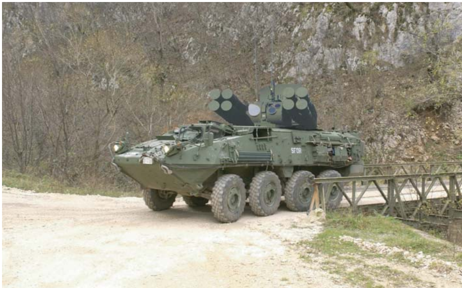
En plus du CAM, l'Armée de terre canadienne étudie la faisabilité d'un « véhicule à effets multimission (VEM) ». L'illustration montre un prototype conceptuel combinant un châssis de VBL et un système de missile ADATS. (Avec la permission du MDN)
