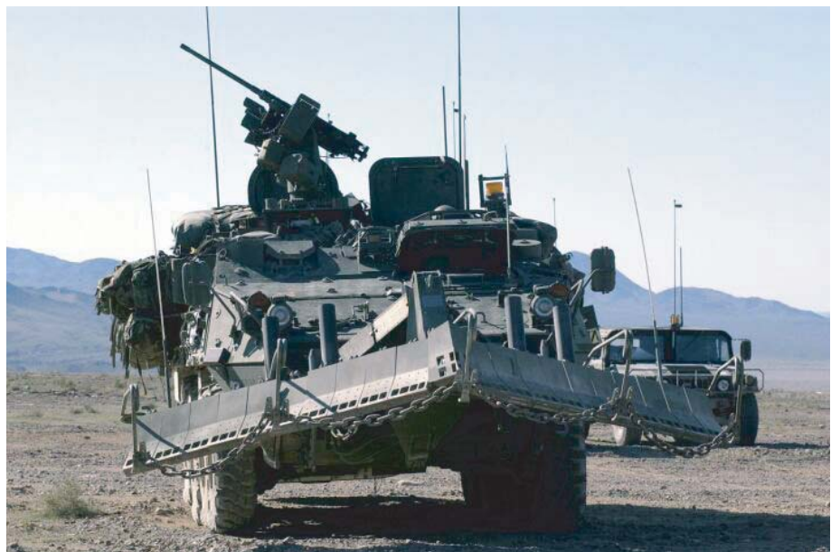
Un VBL « Stryker » adapté pour le génie, présentement à l'essai au sein de l'Armée américaine
