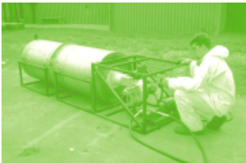
Brûleur portatif mis au point par l'équipe du Centre de technologie environnementale pour brûler en torche les carburants déchets dans des lieux éloignés.
