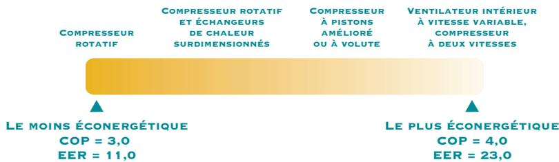
**FIGURE 24. RENDEMENT DES SYSTÈMES À BOUCLE FERMÉE**
