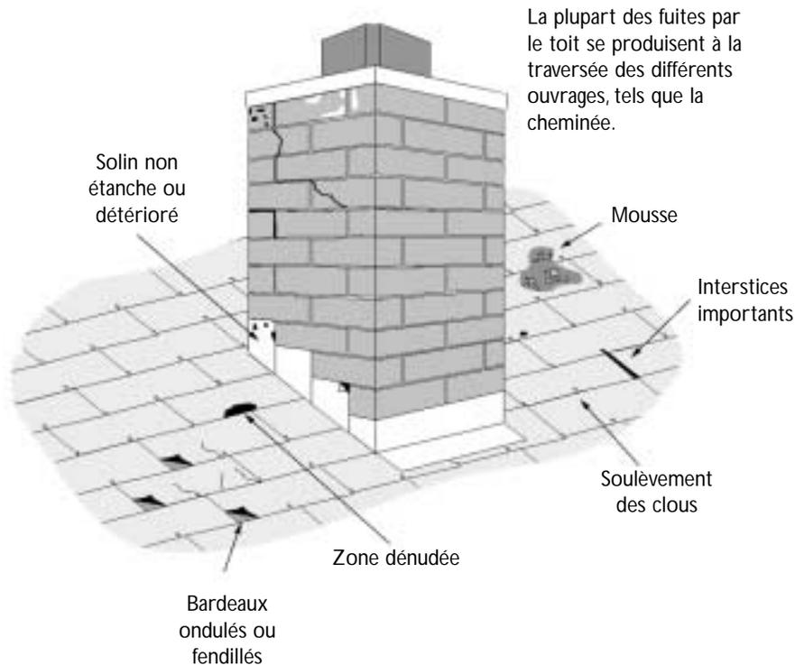
Tout revêtement de toit doit à un moment ou à un autre être réparé ou remplacé. Un entretien régulier comme le nettoyage des gouttières et des descentes pluviales peut prolonger la durée utile de votre toit. En outre, des inspections périodiques peuvent vous permettre de repérer les problèmes avant qu'ils ne causent des dommages coûteux à votre propriété. L'ampleur des problèmes et l'âge du toit sont des facteurs clés pour déterminer si vous devez réparer ou remplacer le revêtement du toit.
