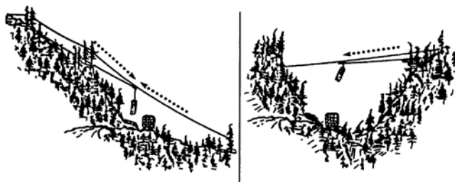
Figure 2.2 - Pont roulant sur câble aérien
