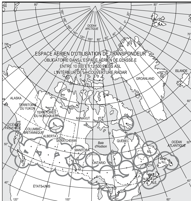
Figure 1.1 – Espace aérien d'utilisation de transpondeur
