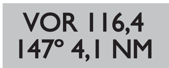
POINT DE VÉRIFICATION DE RADIAL VOR ET DU DME
